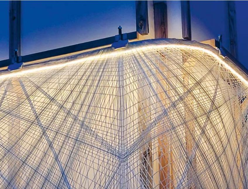
Mögliche Wege zu materialsparendem Bauen sind Strukturen und Hüllen, die sich adaptiv, also selbst regulierend, an wechselnde Umwelteinflüsse anpassen. Überprüft werden die Ansätze am neu errichteten Turm in Form eines 1:1-Experiments.
